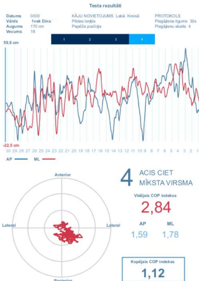
15. attēls. Testa m-CTSIB 4.fāzes (acis ciet, mīksta virsma) datu vizualizācijas piemērs.
