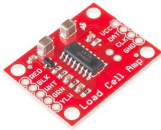
4.attēls. No sensoriem iegūto datu pastiprinātāji HX711.
